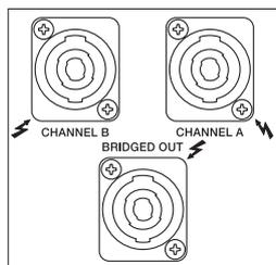
Für die Endstufenkanäle A und B sind jeweils SPEAKON Ausgangsbuchsen vorgesehen. Die BRIDGED OUT Buchse für den Brückenbetrieb ist mit einem Kunststoffdeckel geschlossen, um Anschlussfehler zu vermeiden.
